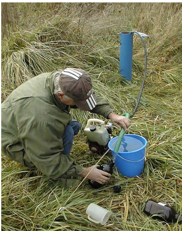
4-4 ábra: Mintavétel figyelőkútból vízminőség vizsgálathoz
