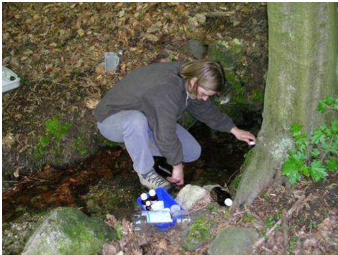
4-3 ábra: Merített mintavétel forrásból vízminőség vizsgálathoz
